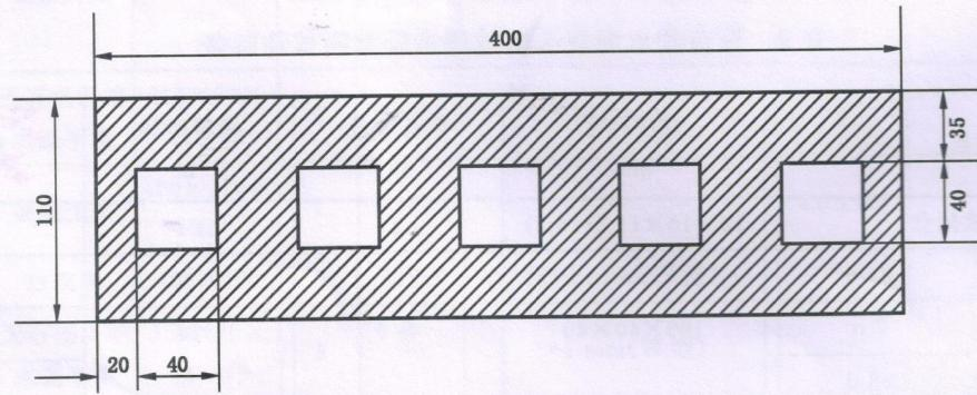
图 2 拉伸粘结强度试件成型模框
