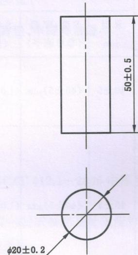
图 1 抗压强度试件成型模具
