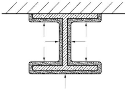
图 1 试件截面上涂层厚度测量点位置
